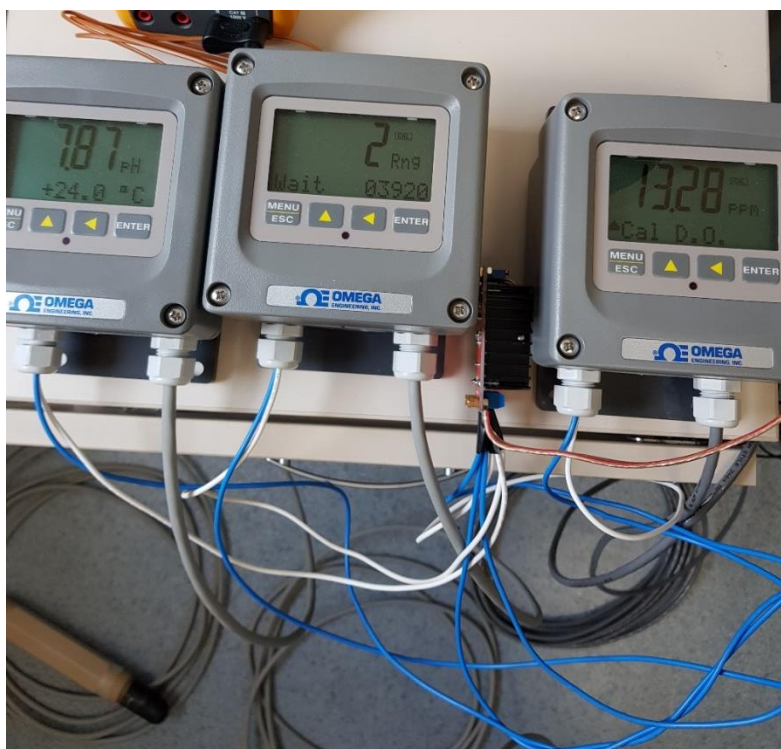
Figura 5 Valori afișate în timpul calibrării senzorului de conductivitate electrică
